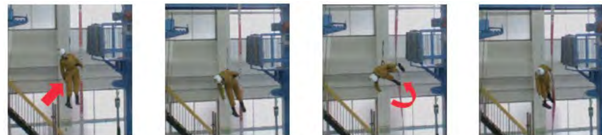
図4-12 胴ベルト型の人体ダミーの挙動
