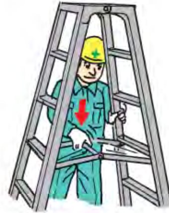
図3-19 開き止めのロックの例
