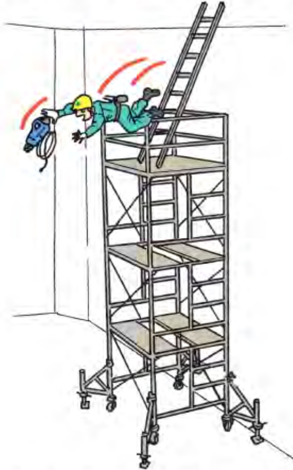
図3-10 移動式足場上ではしごを使用しない
