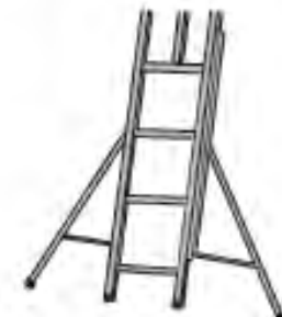
図3-7 安定性補助金具で安定させる一例
