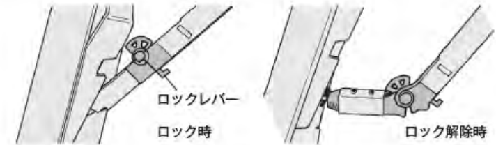
図3-35 開閉機構部のチェック
