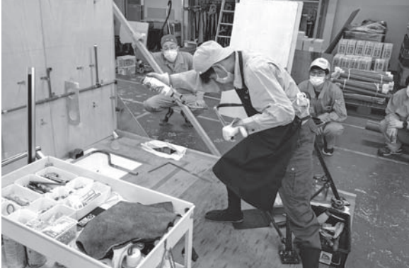
〈東谷選手〉銅管：手曲げ作業
