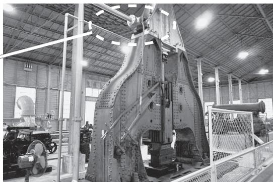
日本国有鉄道鷹取工場にあった別の英国スウェツガーバイドバルカン鉄工所製3t蒸気ハンマーと制御用バルブ(明治14年、輸入品)〈産業遺産、出典：愛知県明治村〉
