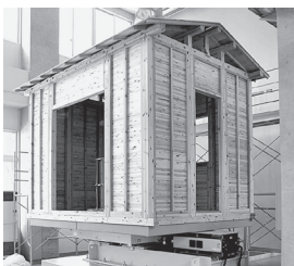
水平2軸加震装置
