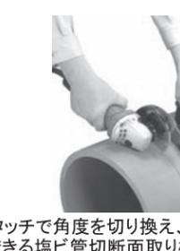
ワンタッチで角度を切り換え、切断と面取りもできる塩ビ管切断面取り機(VPB-300)もラインナップ
